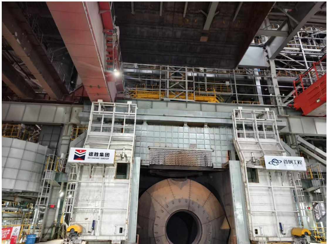
图 3-1 4#100t 提钒转炉主体设施
